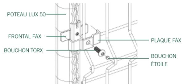
\* Support Fax métallique: fixé à la crémaillère à l'aide de vis de sécurité indémontables de type Torx-05 de M.8x21 fixées à l'aide d'une clé spéciale.
