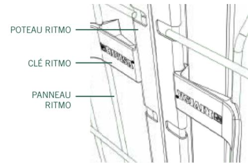
Cales de blocage afin de stabiliser les panneaux durant le séchage du béton. Une fois sec, elles sont retirées et réutilisables.
