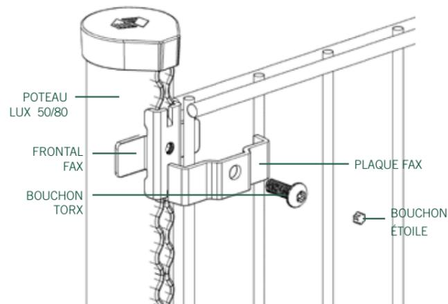
\* Support Fax métallique: fixé à la crémaillère à l'aide de vis de sécurité indémontables de type Torx-05 de M.8x21 fixées à l'aide d'une clé spéciale.
