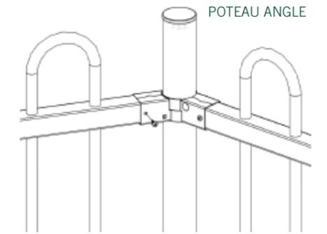
Possibilité de réaliser des changements de direction selon différents angles sans soudure et à l'aide d'un même collier.
